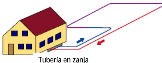
**Figura 7.** Sistema cerrado con intercambiador de calor horizontal de un bucle
